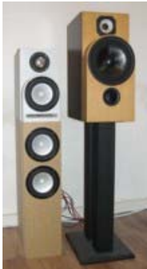
Die Lautsprecher Analog.on Richtig und Analog.on Richtig S mit TQWT Gehäuse Subwoofer
